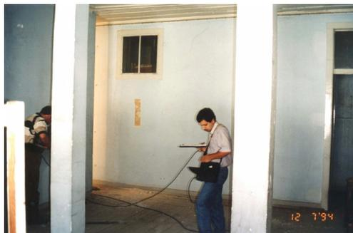
Fig. 3 - Observação termográfica duma parede interior dum edifício pombalino, contendo elementos de madeira. A parede em estudo observada à vista desarmada.
